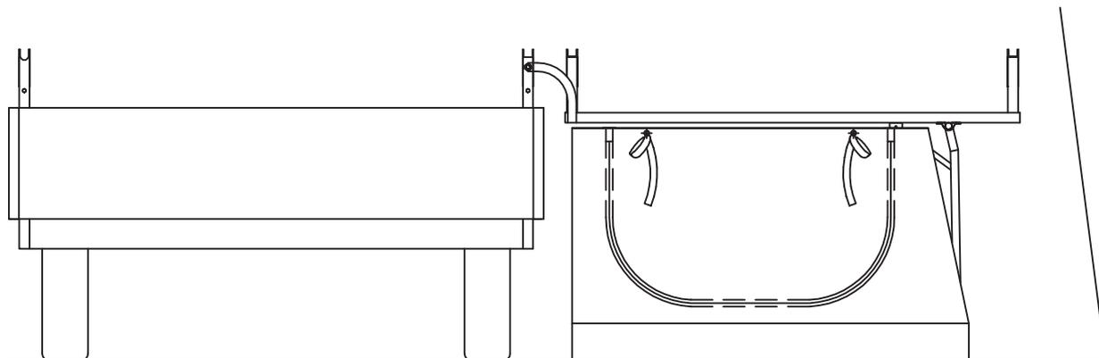
Montage: contre-percer 6 trous  $\varnothing 2,5$  et fixer les pressions avec les vis auto-perçues
